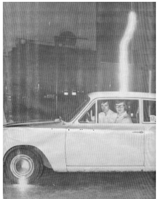
Här stöter EN MILJON VOLT i spänning genom personbilen med sina passagerare - åskforskare som tycker tillvaron är fullständigt normal! Resultat - ett knappt synligt litet märke i bilplåten. Observera blixten som går ut genom framdäcket!
